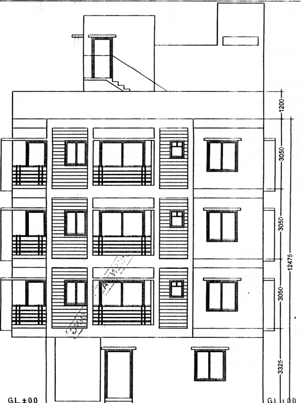
FRONT ELEVATION SCALE: 1:100
